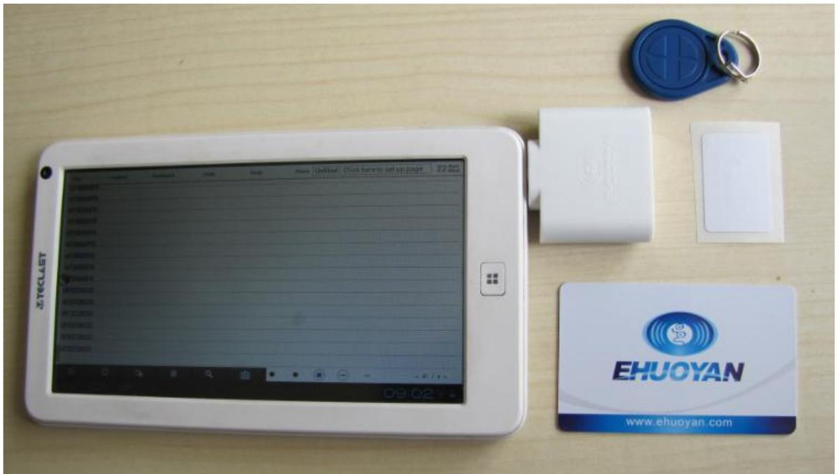
ER200L 能自动感应到 10cm 以内的标签并输出 8 位/14 位唯一的卡序列号到光标所在处然后自动回车结束。所以用户可以打开任意一个文本文档或电子表格之类的进行采集卡序列号。也就是说, 用户刷卡后, 卡的序列号将会自动出现在光标所在的位置, 用户编程的话可以采用接收输入框光标处的内容输入或者接收键盘输入, 读卡器其实就是通过模拟敲键盘的方式逐个输出卡的序列号到光标所在位置, 因此, 用户不需要用到第三方的
