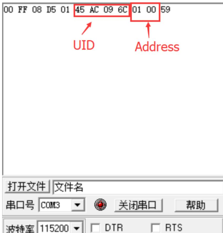
上图的 Len=0x08 表示后面有 8 个字节的的数据，D5 01 是 TFI，45AC096C 是这个卡的卡号，01 00 表示读卡器节点地址，节点地址可以设置，2 个字节组成，低字节在前，59 表示从 D5 到 00 这些数据逐个字节异或的计算结果。
